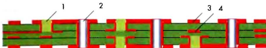
**Рис. 4.21.** Структура МПП попарного прессования:
