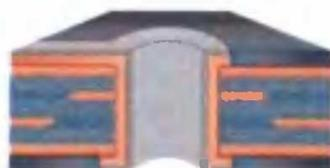
*Продолжение рис. 4.27.* Последовательность изготовления МПП классическим методом металлизации сквозных отверстий
