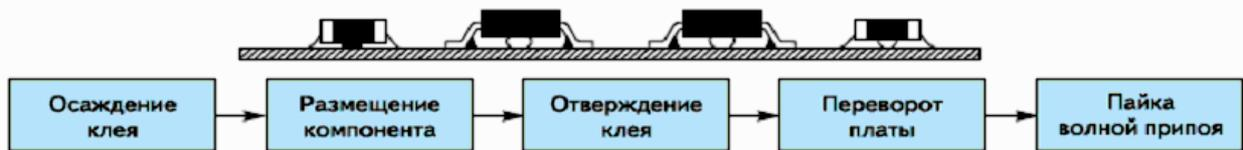
*Рис. 6.2.* Односторонняя сборка поверхностного монтажа, только пайка погружением
