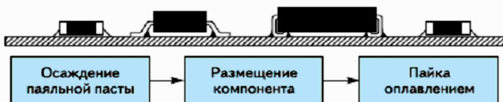
**Рис. 6.1.** Односторонняя сборка поверхностного монтажа для компонентов поверхностного монтажа, только пайка оплавлением
