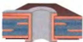
Фоторезист удаляется, оставляя металлорезист на проводниках и в отверстиях, и обнажает медь в пробельных местах (зазорах). Медь, покрытая металлорезистом, останется не вытравленной и формирует топологию внешних слоев платы (МПП).
