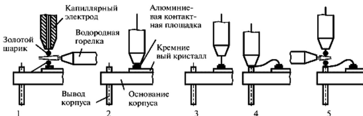
**Рис. 5.15.** Схема процесса микросварки:
