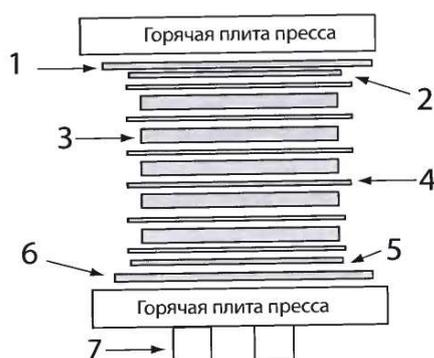
**Рис. 4.28.** Порядок укладки пакетов препрега с фольгой и прокладочных листов между плитами пресса:
