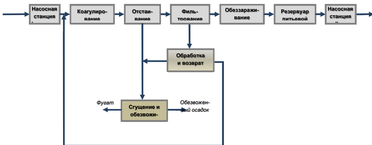
Рисунок 1 – Традиционная технологическая схема очистки природной воды
