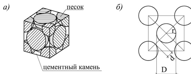
Рисунок 1 – Используемая в работах [2-5] модель раствора для аналитического определения радиационных и термических изменений его объема: а – объемный вид фрагмента модели; б – сечение фрагмента модели
