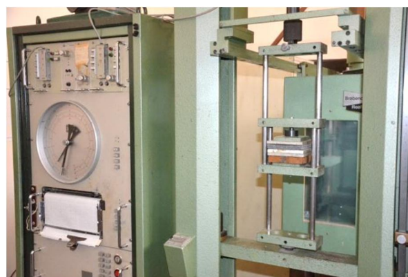
Рисунок 2 – Испытание на сжатие на универсальной испытательной машине
