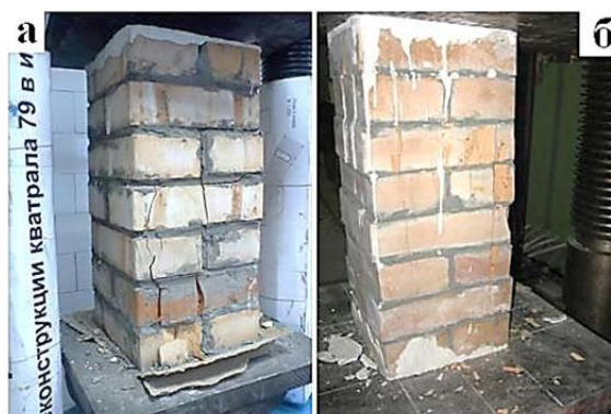
Рисунок 4 – Образцы кладки после испытания: а – традиционной; б – высококачественной
