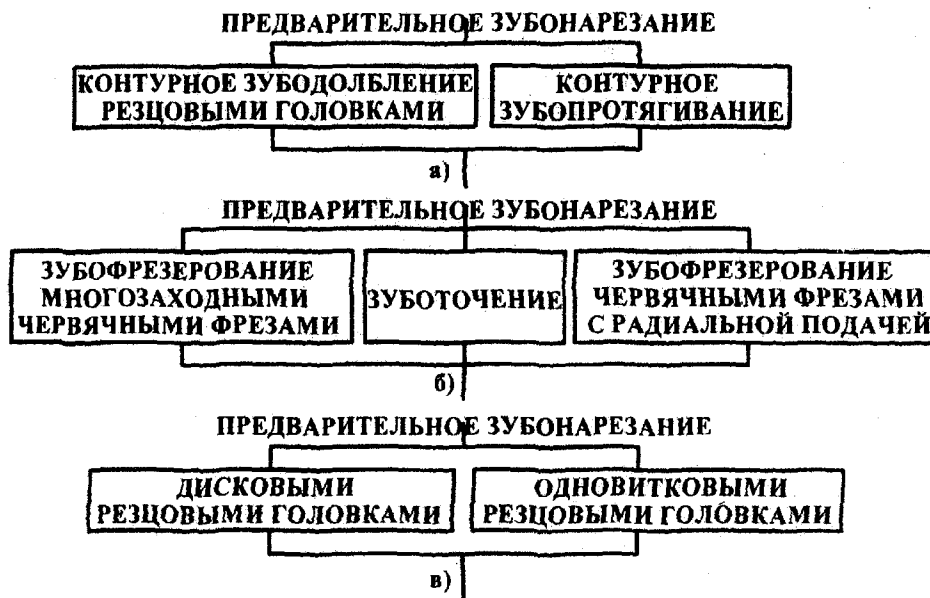
Рис. 2. Варианты прогрессивных технологических схем зубонарезания цилиндрических колес
