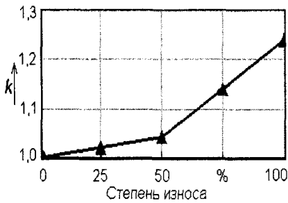
Рис. 7. Зависимость среднего значения k режущей кромки резца с пластиной 0025 T5K10 от ее износа
