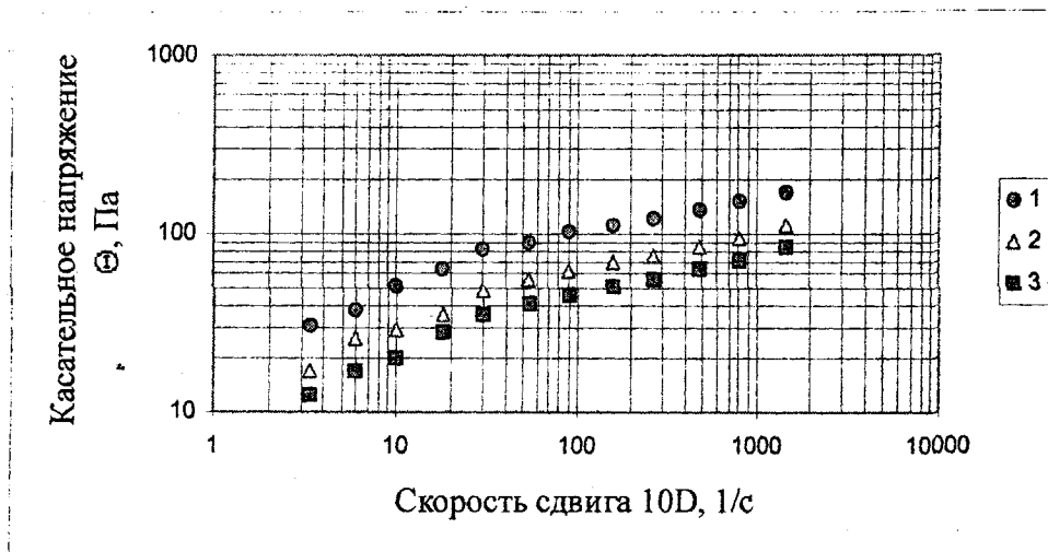
Рис. 1. – Экспериментальные точки кривых течения гомогенизированного соуса «Рубиновый» с содержанием сухих веществ: 1 – 21%, 2 – 19% и 3 – 17% (нагружение) в логарифмических координатах
