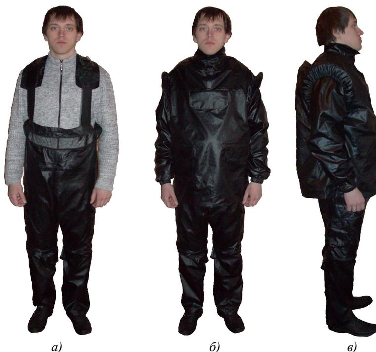
Рисунок 4 – Спецдежда для защиты в условиях субнормальных температур. Внешний вид
