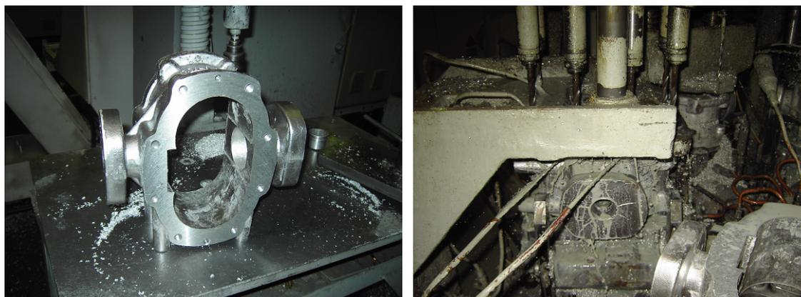
*Рисунок 2 – Сверление 8 отверстий под резьбу М12 на шестипозиционном агрегатном станке 3XA4912П*
