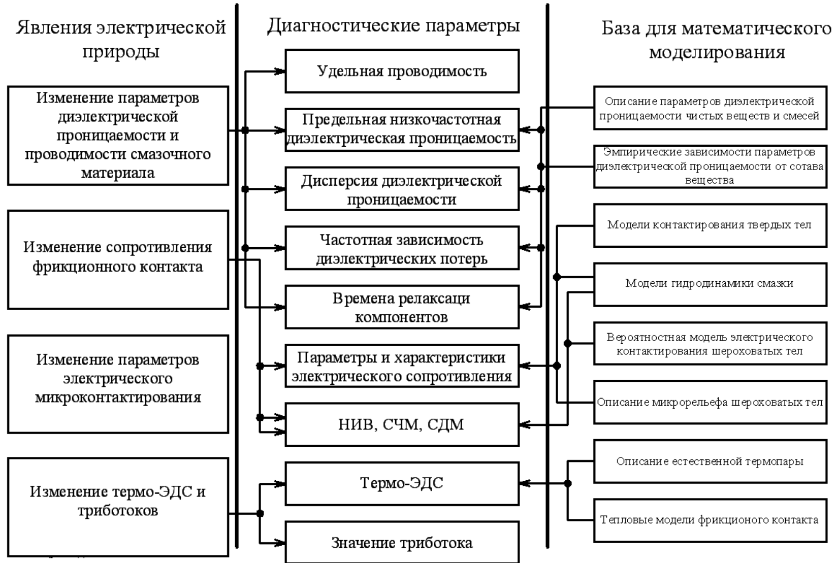
Рисунок 2 – Основы для моделирования процессов в зоне трения при исследовании явлений электрической природы
