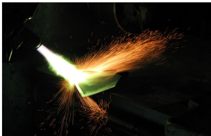
Рисунок 1 – Оплавление напыленной лапы культиватора
