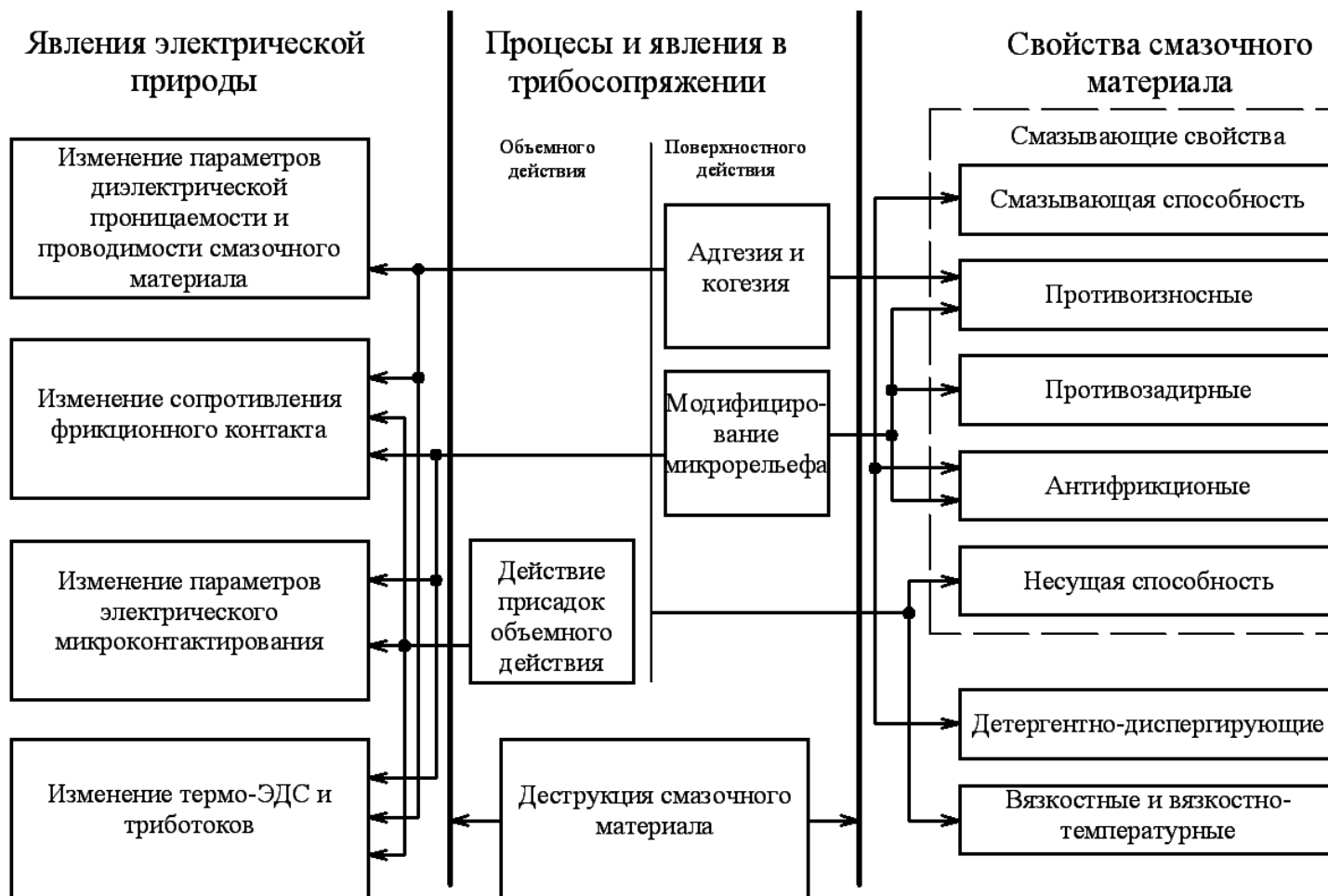
Рисунок 1 – Связь свойств смазочных материалов и ТТ с процессами и явлениями в трибосопряжении
