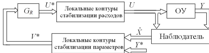
Рисунок 3 – Структурная схема связанной системы стабилизации
