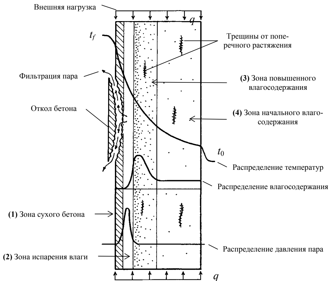
Рисунок 1 – Механизм взрывообразного разрушения бетона при нагреве
