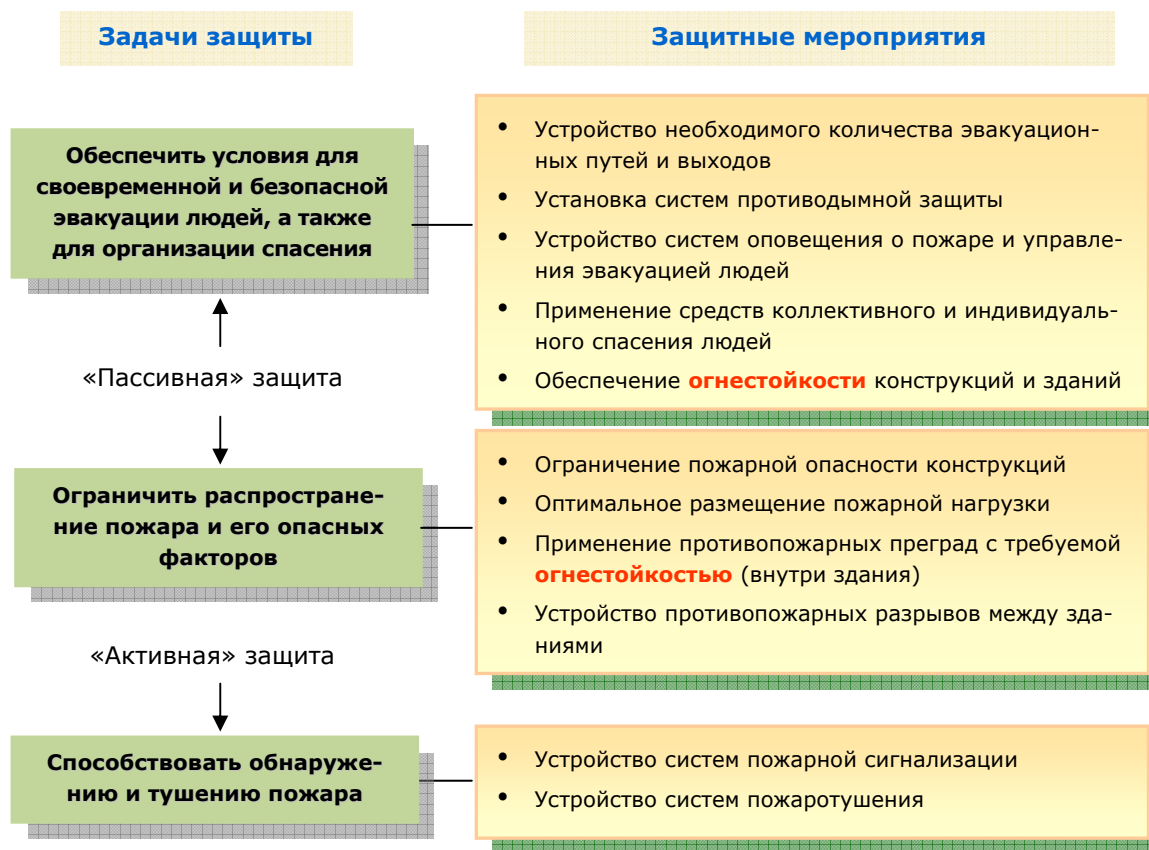
Рисунок 5 – Структура системы противопожарной защиты зданий
