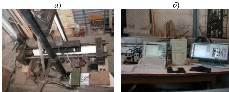
Рисунок 3 – Общий вид испытания железобетонного элемента при косом внецентренном кратковременном динамическом сжатии (а) и используемая измерительная аппаратура (б)
