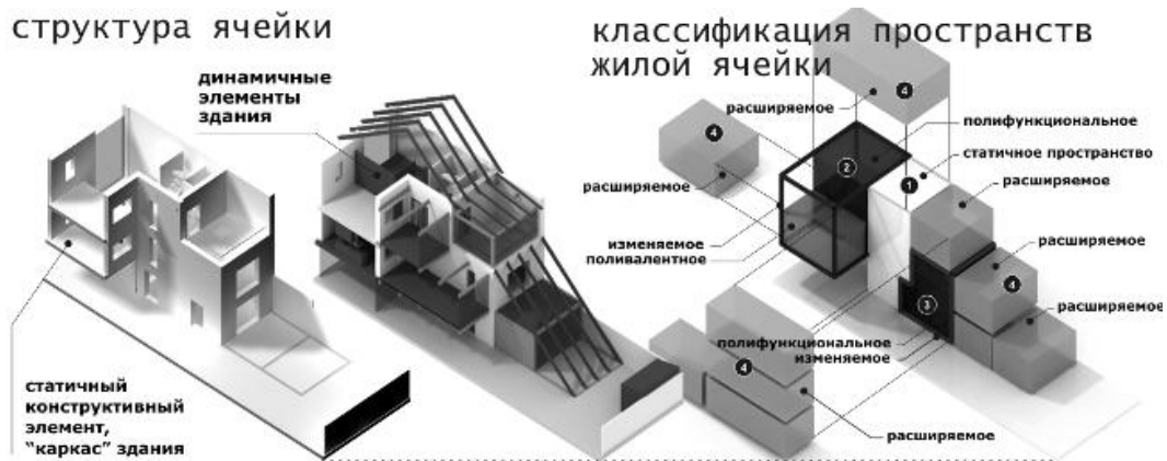
Рисунок 3 – Структура жилой ячейки и классификация жилых пространств
