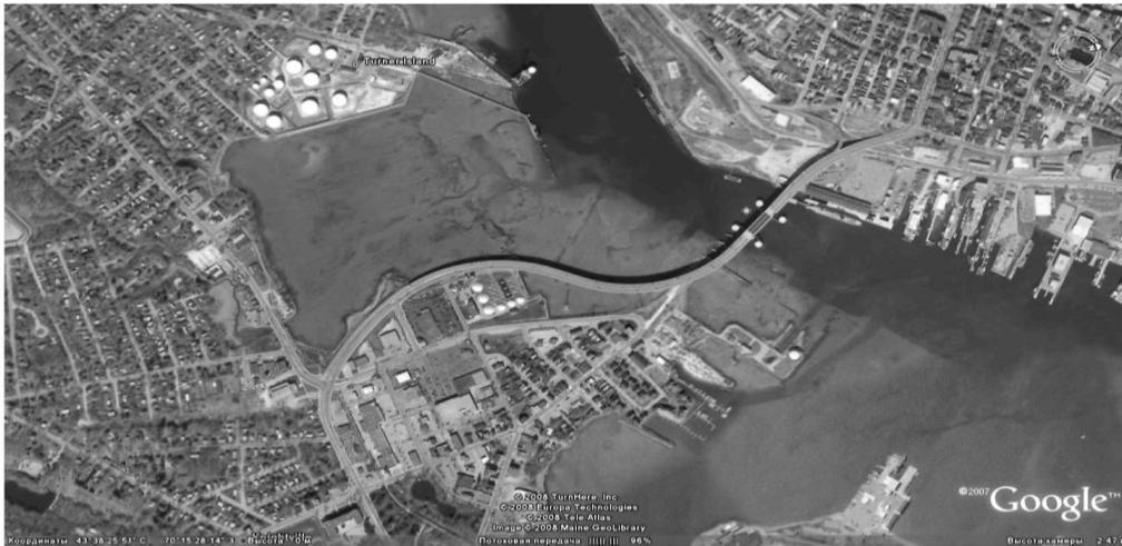
Рис. 7. Фотография из космоса разводного моста во время отлива (белые точки – защитные мостовые заграждения) длина моста 1 км (штат Мэн).
