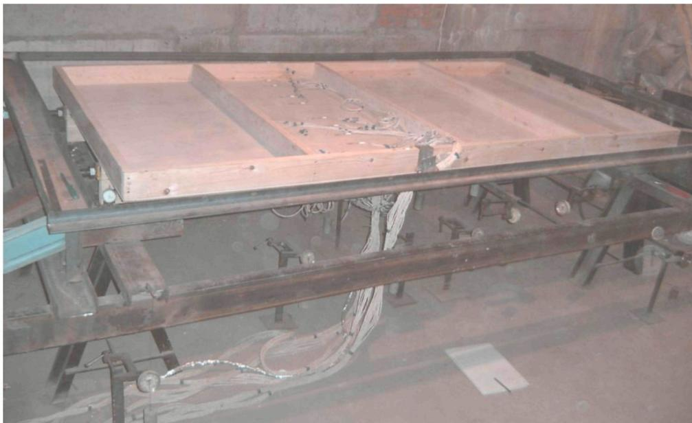
Рис. 3. Опытная конструкция, установленная на испытательный стенд
