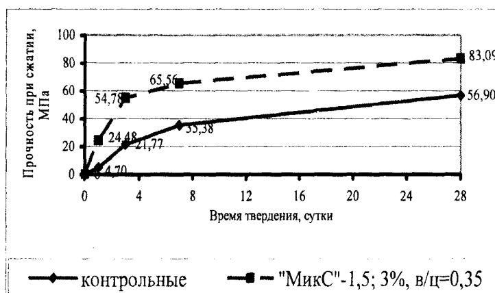
Рис. 1. Кинетика изменения прочности с добавкой «МикС»-1,5 при сжатии
