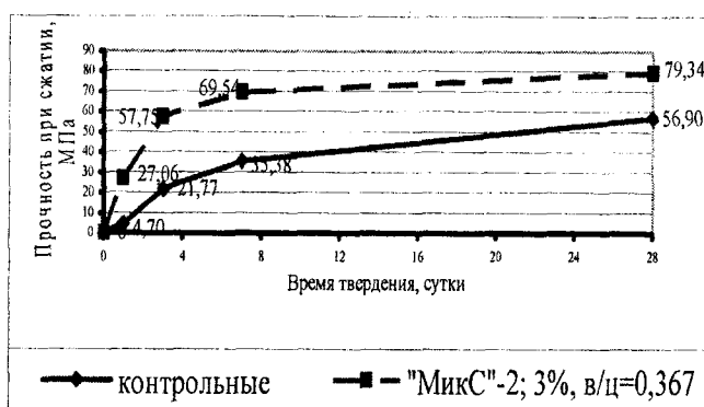
Рис. 3. Кинетика изменения прочности с добавкой «МикС»-2 при сжатии
