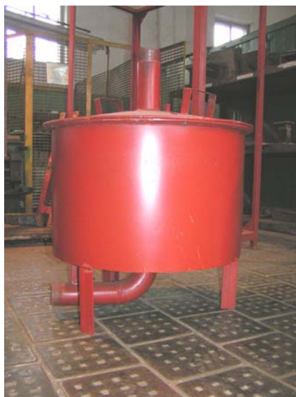
Рис. 3. Экспериментальный образец приёмно-заборного устройства битума
