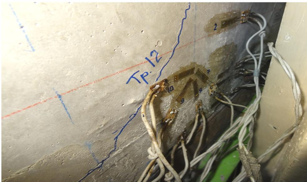
Рисунок 2 – Общий вид установки электротензорезисторов на бетон
