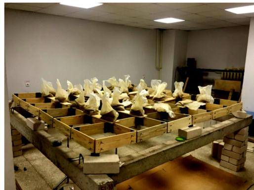
Рисунок 5- Загружение СПБ сосредоточенной нагрузкой в центральных узлах
