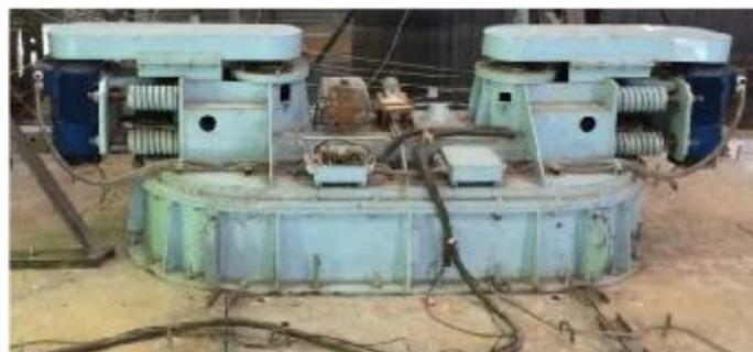
Рисунок 4 – Общий вид вибромашины инерционного действия ВИД-50
