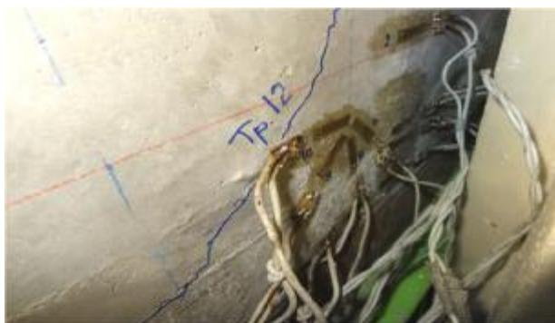
*Рисунок 4 – Общий вид установки электротензорезисторов на бетон*
