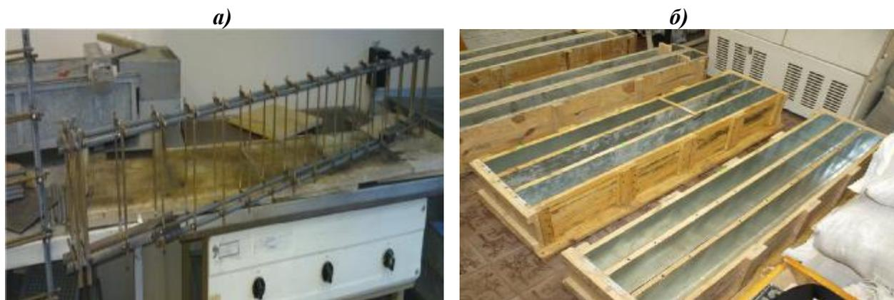
*Рисунок 1 – Конструкции каркасов (а) и опалубочные формы (б)*
