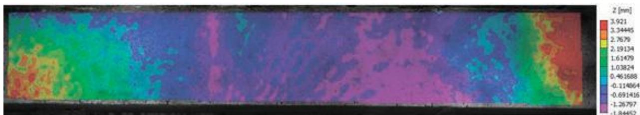
Рисунок 7 – Область анализа измерений прогибов ригеля системой VIC-3D
