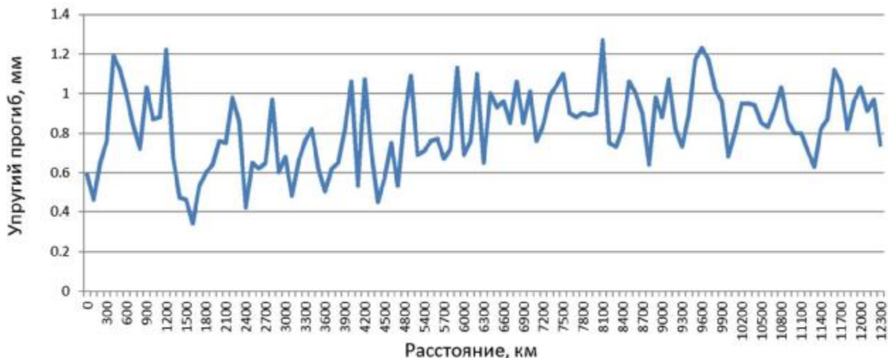
Рисунок 1 – Результаты регистрации упругого прогиба на эксплуатируемом участке автомобильной дороги
