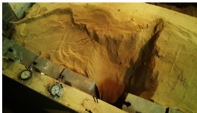
Рисунок 4 - Потеря живучести системы «грунт – подпорная стена - основание» из-за крена, сдвига сооружения и неконтролируемого перемещения откоса грунта
