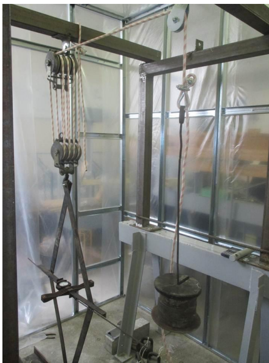
Рисунок 2 – Схема (а), (б) и общий вид установки (в) для оценки прочности и устойчивости центрально-сжатого стержня из древесины. 1 - рабочая шарнирно-стержневая система; 2 - канат; 3 - несущая рама шарнирно-стержневой системы; 4 - неподвижная обойма блока полиспаста; 5 - неподвижная обойма блока полиспаста; 6 - подвижная обойма блока полиспаста; 7 - груз; 8 - несущая рама полиспаста, 9 - исследуемый стержневой элемент из анизотропного материала; 10 - тензорезистор
