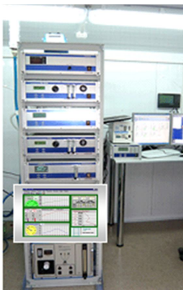
Рисунок 1 – Автоматическая станция контроля загрязнения атмосферного воздуха, определения актинометрических и метеорологических параметров (левое фото); сектор натуральных испытаний эколого-метеорологической лаборатории (правое фото)
