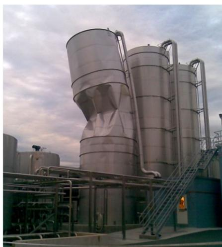
*Рисунок 14 – Местная потеря устойчивости стального резервуара*
