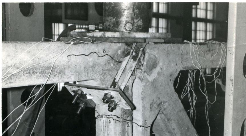
Рисунок 7 – Усиление стойки в процессе испытания
