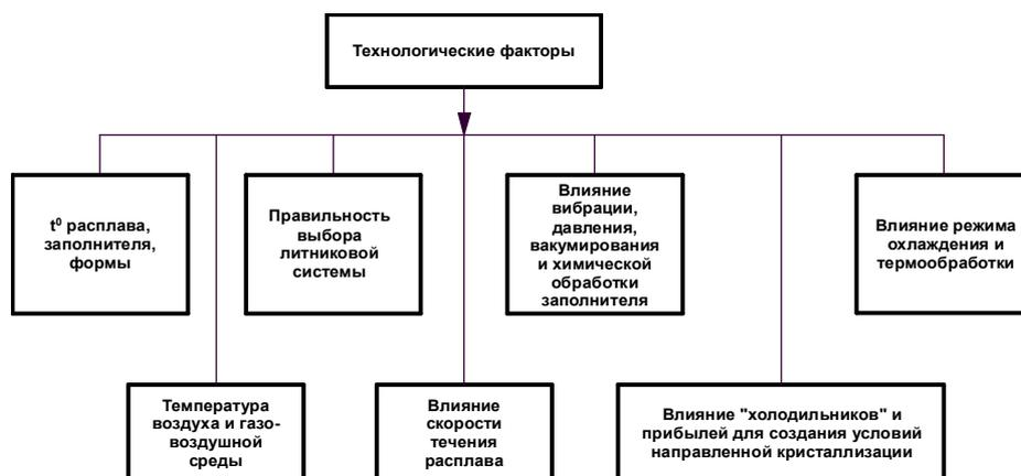
Рисунок 1 – Технологические факторы, влияющие на прочностные и другие показатели металлобетонов
