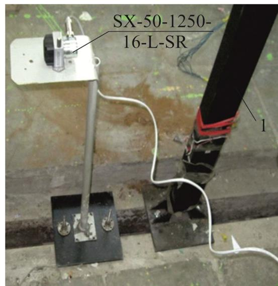
Рисунок 4 – Установка тросового датчика
