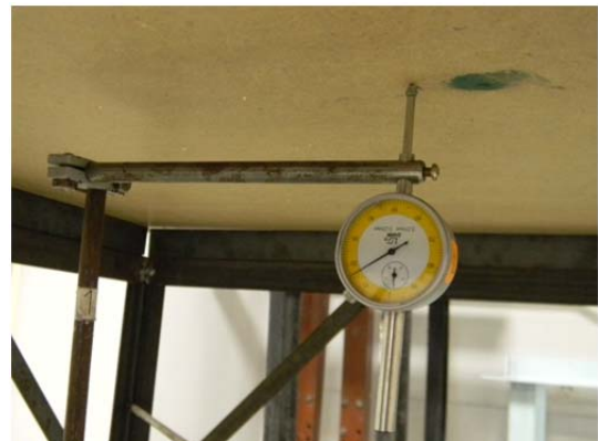
Рисунок 4 – Индикатор часового типа ИЧ-25
