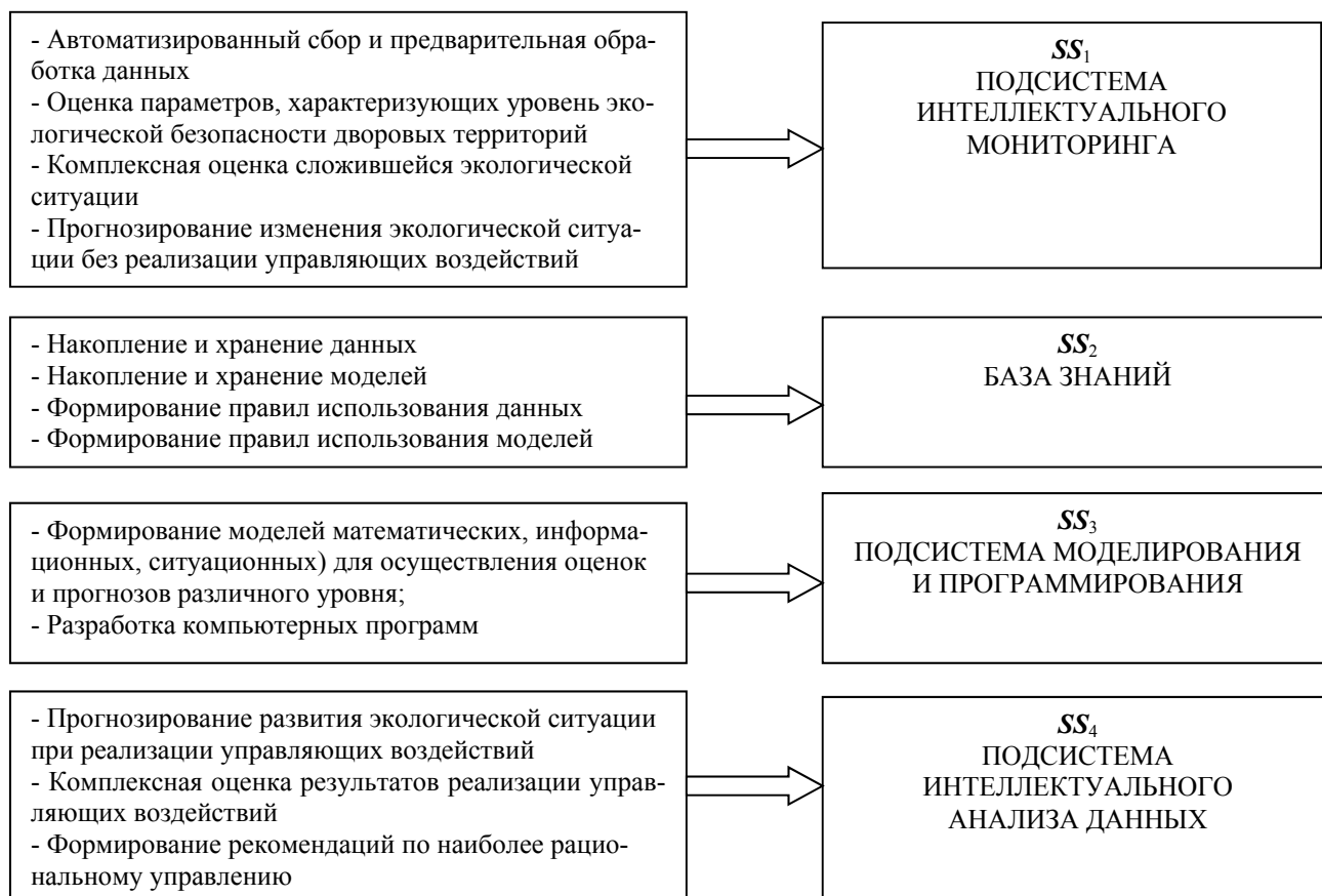
Рисунок 3 – Функции и реализующие их подсистемы ИСППР
