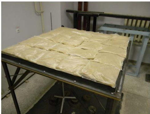
Рисунок 3 – Моделирование равномерно распределенной нагрузки
