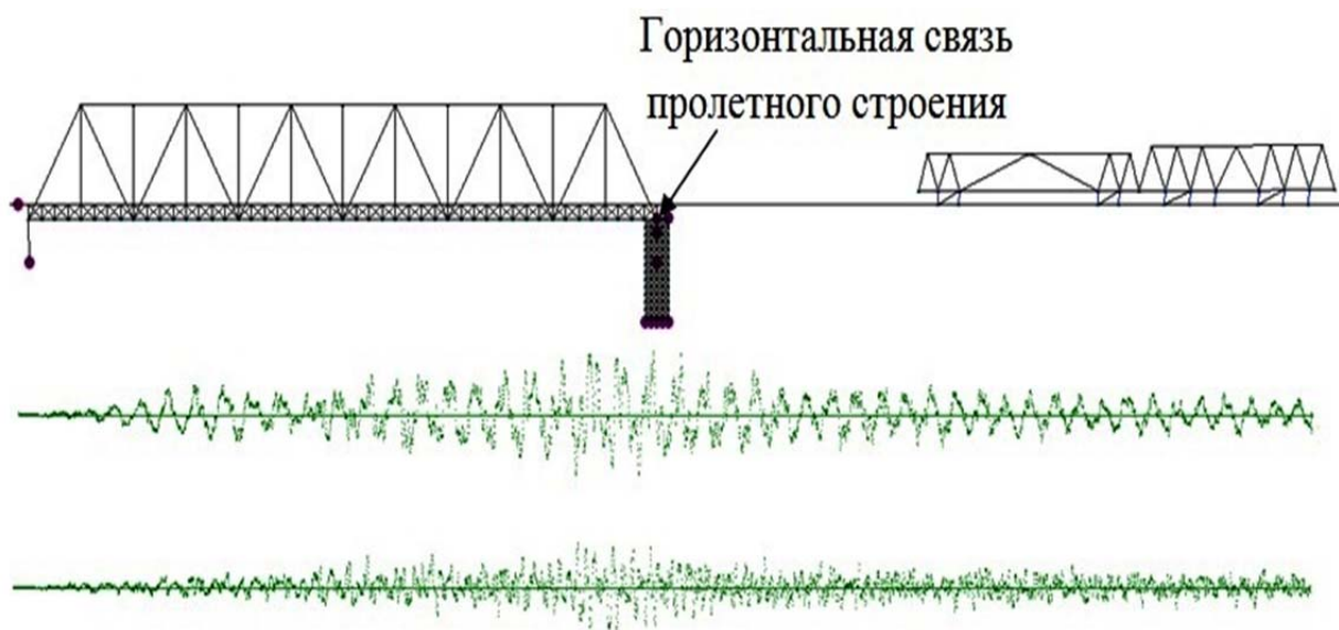
Рисунок 5 – Графики изменения горизонтальной опорной реакции от времени при скорости движения поезда 100 км/м и массе подвижного состава 238 т. Время расчета 4 сек. Верхний график – жесткое крепление горизонтальной связи, нижний график – опирание горизонтальной связи на массивную упругую опору
