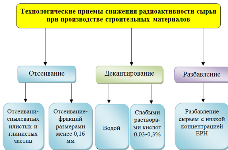
Рисунок 1 – Технологические приемы снижения содержания естественных радионуклидов в сырье для производства строительных материалов
