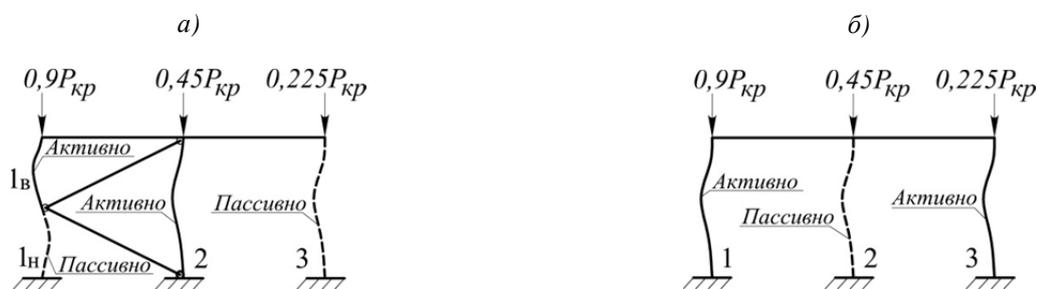
Рисунок 2 – Формы потери устойчивости исходной рамы (а) и рамы с выключенной связью (б)
