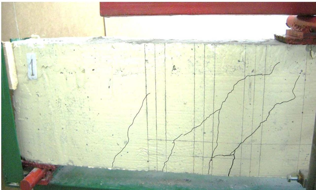
Рисунок 4 – Картины образования и развития трещин в опытной конструкции третьей серии БС-III-2,7-100-Ø10-(п2)
