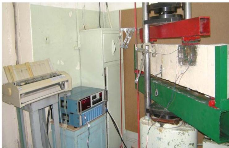
*Рисунок 2 – Общий вид лабораторных испытаний железобетонных составных конструкций по наклонным сечениям*
