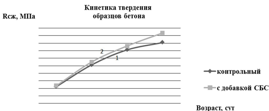
Рисунок 2 – Кинетика твердения образцов бетона: 1 – контрольный без добавки; 2 – с добавкой СБС
