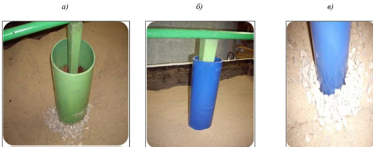
**Рисунок 1 – Иллюстрации испытаний штампа в обсадных трубах в грунтовой лотке:**
