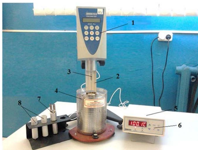
**Рисунок 1 – Внешний вид вискозиметра BROOKFIELD RVDV-II+PRO**
