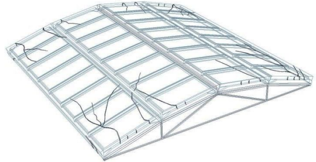
Рисунок 2 – Общий вид испытаний крупномасштабной модели складчатого покрытия (а); схема образования трещин (б)
