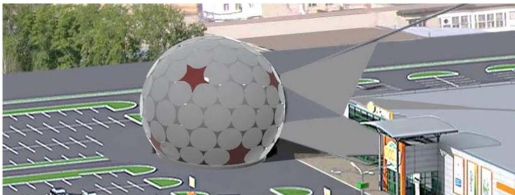
*Рисунок 10 – Запроектированное сборное сферическое покрытие аквапарка
