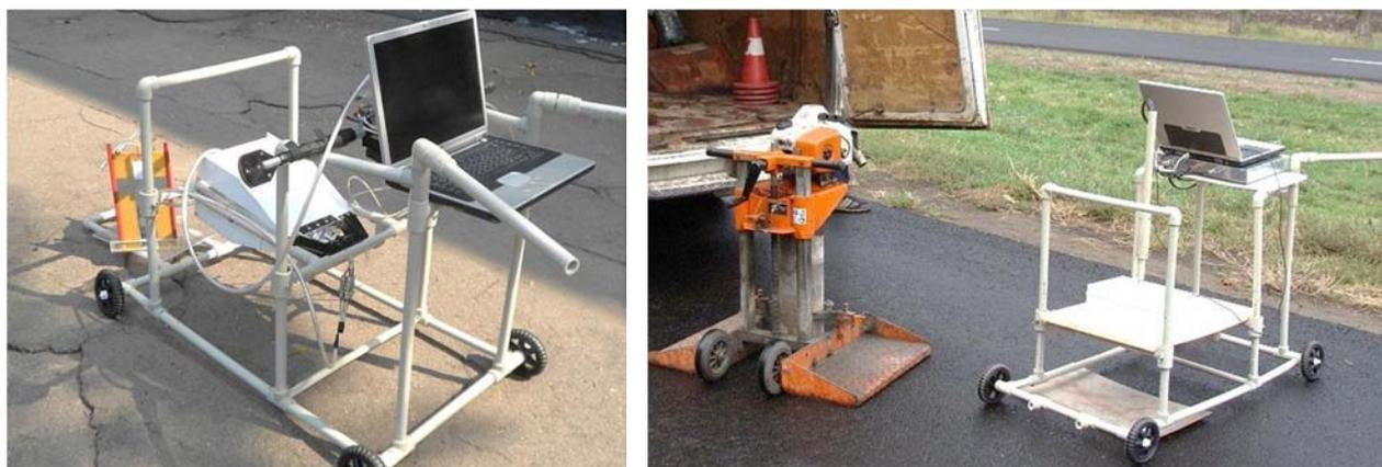
Рисунок 3 – Оборудование для георадарного обследования дорожных одежд
