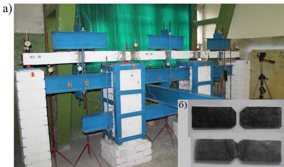
Рисунок 3 – Общий вид испытаний неразрезных балок на живучесть (а) и конструкция надпорной прокалиброванной детали (б)
