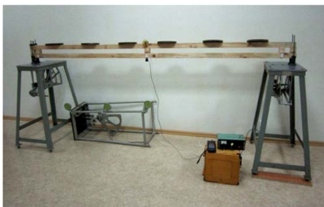
Рисунок 3 – Установка для испытания балок
