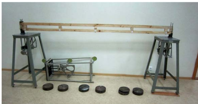
Рисунок 2 – Испытание на статическую нагрузку составной балки с пятью нагелями и пятью прокладками
