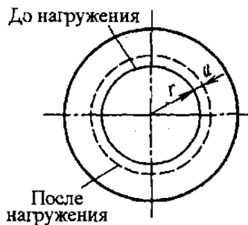
Рисунок 4 – Длина окружности, проведенной внутри цилиндра до и после его нагружения (до и после повреждения арматуры коррозией)
