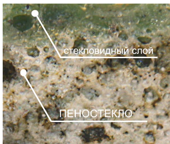
Рисунок 2 – Срез образца композиционного материала (увеличение в 40 раз)
