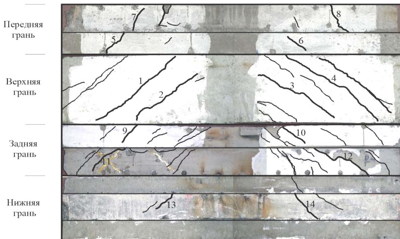
*Рисунок 2 – Характер разрушения железобетонных образцов по пространственным сечениям*
