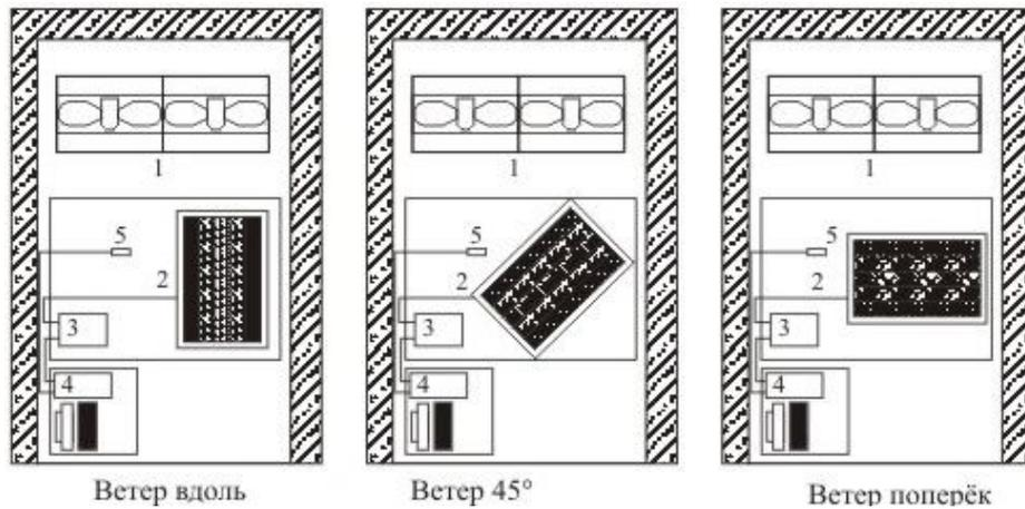
Рисунок 1 – Схема эксперимента по определению теплового потока с поверхности модели сооружения: 1 – вентилятор; 2 – модель сооружения; 3 – мультиметр (регистратор); 4 – ПК; 5 – оптический пирометр
