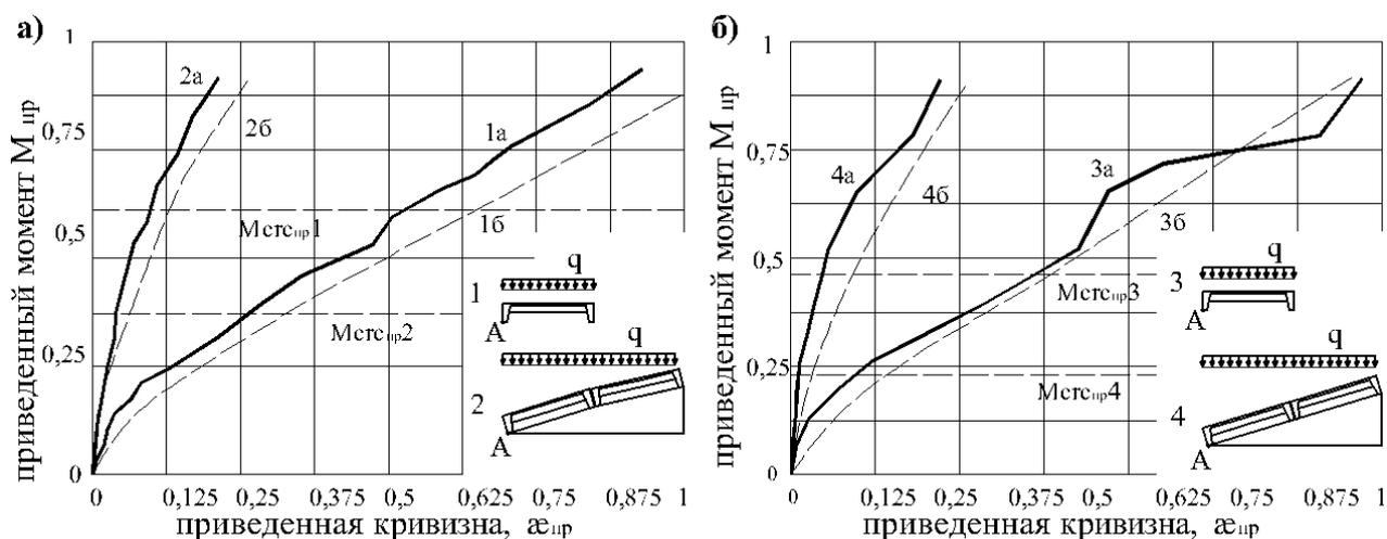
**Рисунок 4 – Приведенная зависимость «момент-кривизна» для среднего поперечного сечения крайнего нижнего продольного ребра модели складки (а) и натурной складки (б) представленной в работе [4]; (кривые 1а, 2а, 3а, 4а – опытные, кривые 1б, 2б, 3б, 4б – расчетные).  $M_{пр} = M/M_u$ ,  $\alpha_{пр} = \alpha/\alpha_u$**
