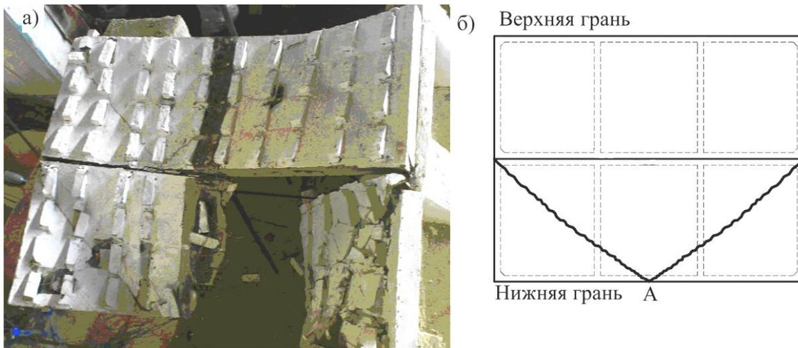
Рисунок 3 – Общий вид разрушенной модели фрагмента складки (а) и ее схема разрушения (б); А – точка обрыва арматуры по уменьшенному сечению
