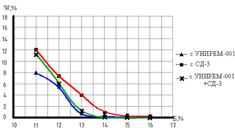
Рисунок 2 – Зависимость водонасыщения асфальтовяжущего  $W$  от количества битума  $B$
