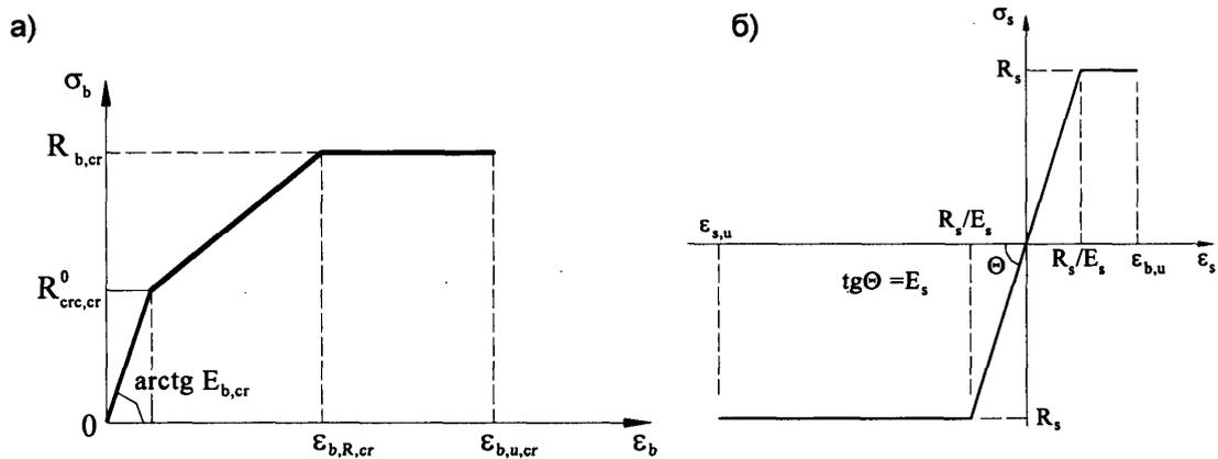
Рисунок 1 – Диаграмма деформирования «σ-ε» бетона (а) и арматуры (б)
