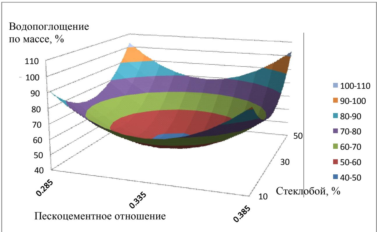
*Рисунок 3 – Зависимость водопоглощения по массе пенобетона от пескоцементного отношения и процентного содержания стеклобоя при содержании жидкого стекла 3% от массы цемента*
