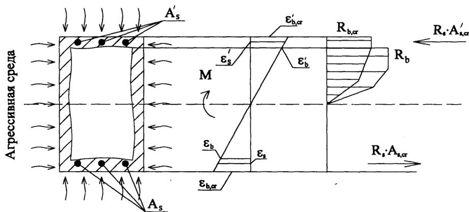
Рисунок 2 – Напряжено-деформированное состояние железобетонного элемента с коррозионными повреждениями
