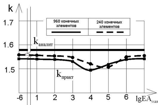
Рисунок 5 – Изменение коэффициента  $K$  в зависимости от жесткости связей сдвига и количества конечных элементов при шарнирном опирании по контуру
