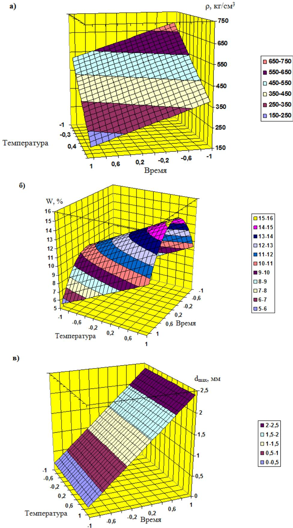
Рисунок 1 – Зависимость плотности (а), водопоглощения (б) и максимального диаметра пор (в) от температуры и времени вспенивания при стабилизированной концентрации шлака на нулевом уровне
