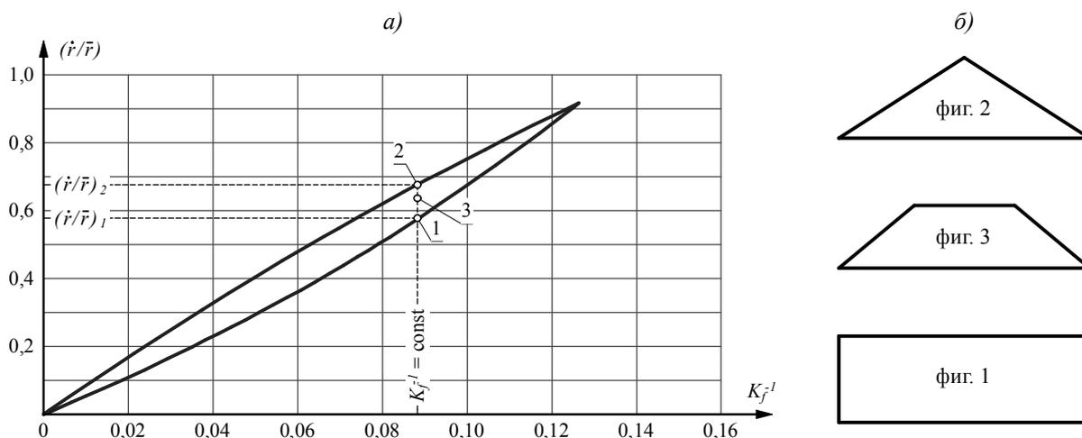
Рисунок 5 – Способ интерполяции значений  $\dot{r}/\bar{r}$  при  $K_f = \text{const}$
