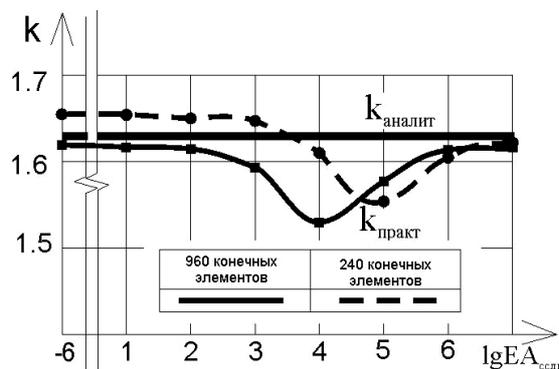
Рисунок 7 – Изменение коэффициента  $K$  в зависимости от жесткости связей сдвига и количества конечных элементов при жестком защемлении по контуру
