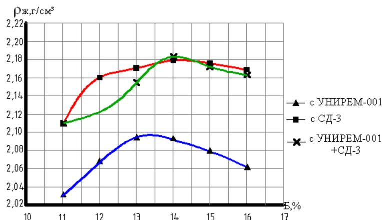
Рисунок 1 – Зависимость средней плотности асфальтовяжущего  $\rho_{ж}$  от количества битума  $B$
