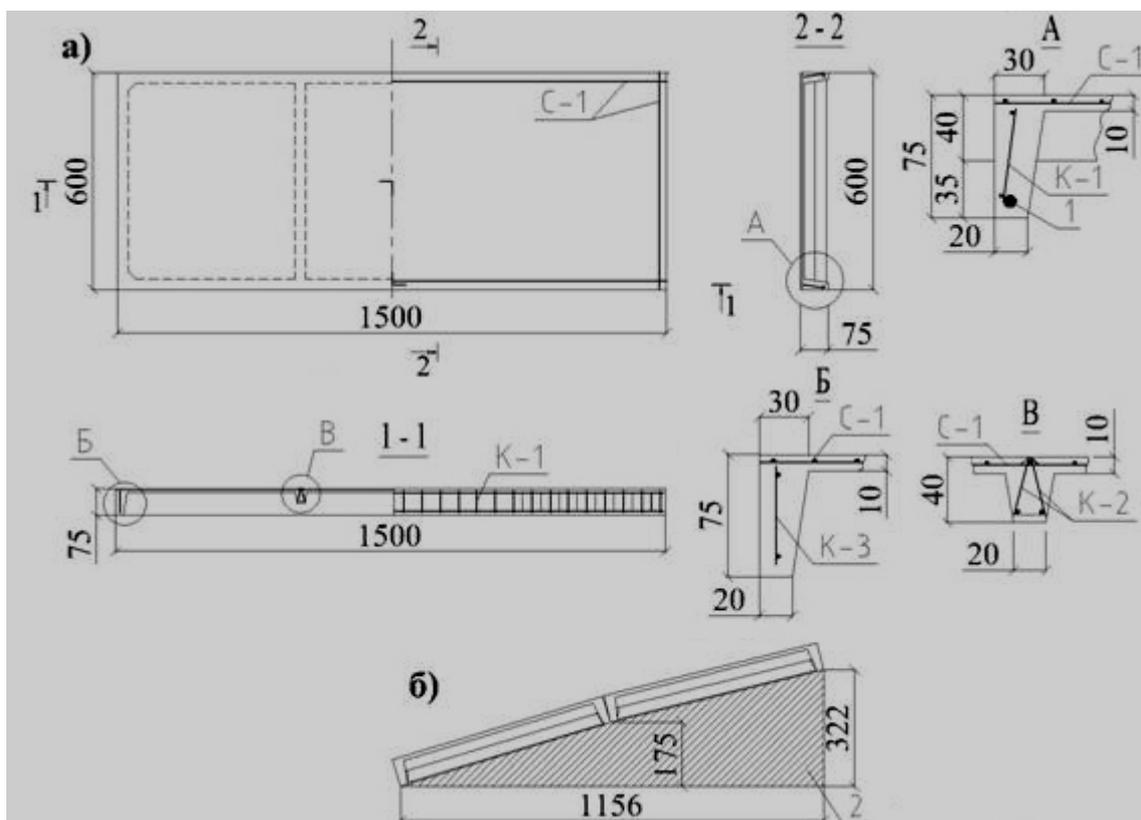
**Рисунок 1 – Конструкция опытных моделей плит (а) и геометрия поперечного сечения модели складки (б): 1 – рабочая арматура; 2 – испытательный стенд; К-1 – каркас продольный; К-2 – каркас поперечный; К-3 – каркас торцевой; С-1 – сетка**
