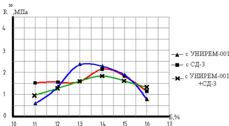
Рисунок 3 – Зависимость прочности при сжатии при 50°С асфальтовяжущего  $R_{50}$  от количества битума Б
