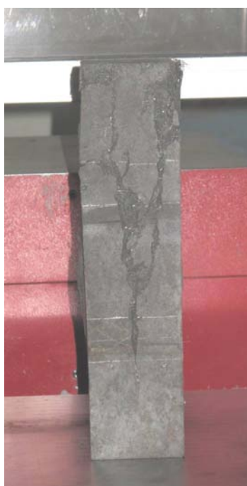
Рисунок 2 – Призмический образец после разрушения
