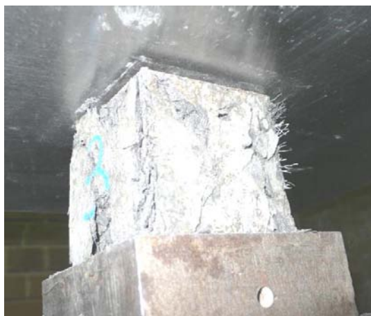
Рисунок 1 – Кубический образец после разрушения
