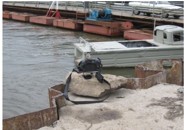
Рисунок 5 – Съемка колебаний моста оптическим измерителем
