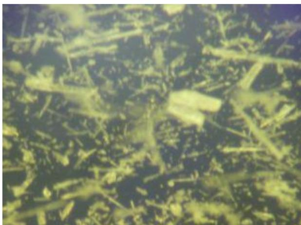
*Рисунок 1 – Микрофотография волластонитового минерального порошка увеличение X 100*
