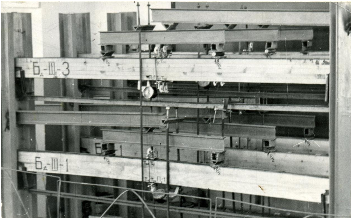
Рисунок 1 – Испытание балок пролетом 3 м
