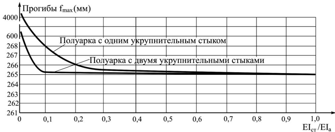
Рисунок 4 – Максимальные прогибы полуарок с одним и двумя укрупнительными стыками в зависимости от жесткости стыков
