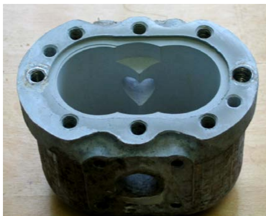
Рисунок 5 – Восстановленный корпус шестеренного насоса НШ-32У-2 пластическим деформированием с упрочнением плазменным электролитическим оксидированием
