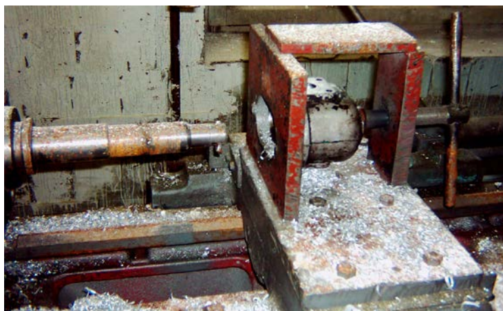
Рисунок 4 – Механическая обработка колодцев корпуса насоса НШ-32У-2
