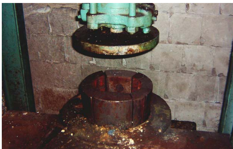
Рисунок 2 – Пресс-форма для обжатия корпусов насосов типа НШ-У
