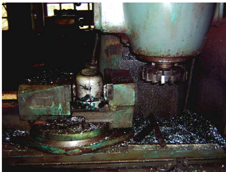
Рисунок 3 – Фрезерование дна корпуса насоса НШ-32У-2
