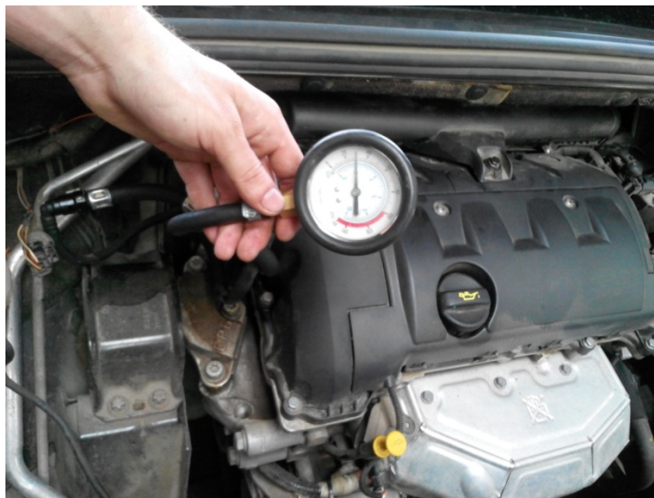
Рисунок 4 – Проверка давления топлива на участке «топливный фильтр - ТНВД» двигателя EP6 автомобиля Peugeot 408
