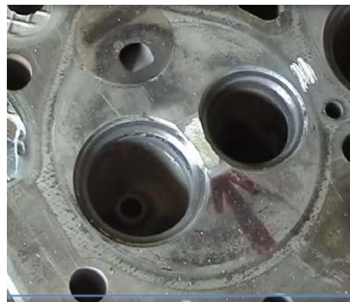
Рисунок 4 – Общий вид ГБЦ: а) до восстановления; б) после восстановления
