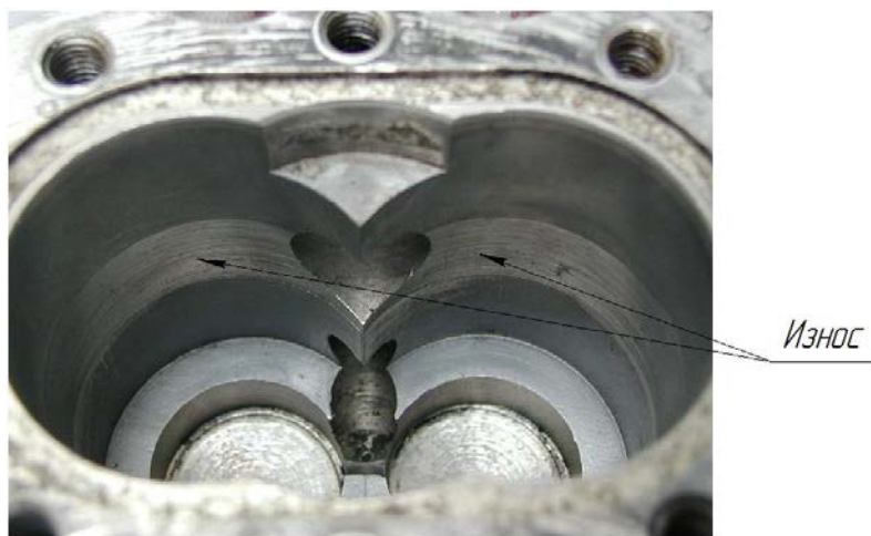
Рисунок 1 – Изношенный корпус шестеренного насоса НШ-32У-2
