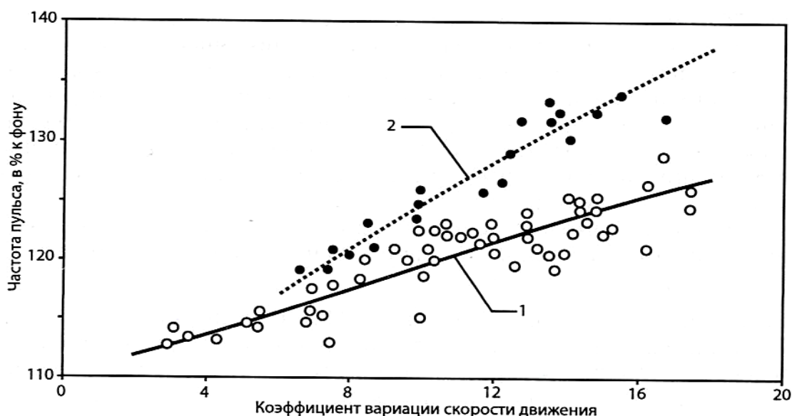
Рисунок 3 - Взаимосвязь коэффициента вариации скорости движения автомобиля и частоты пульса водителей на дорогах в пересеченной (1) и горной местности (2)
