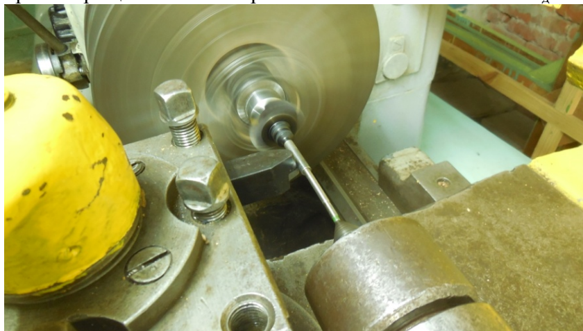
Рисунок 2 - Выглаживанием поверхности вала турбокомпрессора после электроискровой обработки
