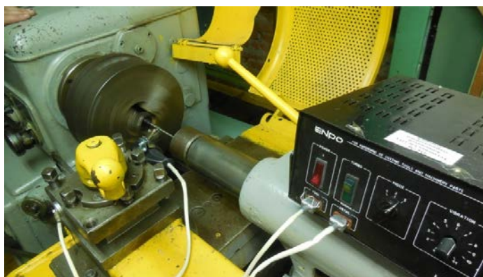
Рисунок 1 - Токарно-винторезный станок 1К62 с интегрированной в него установкой для электроискровой обработки UR-121
