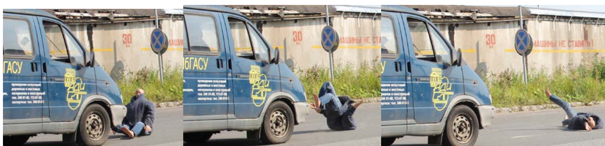
Рисунок 3 – Скольжение манекена по поверхности дорожного покрытия
