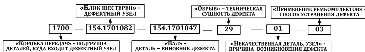
Рисунок 1– Описание дефекта в виде составного кода
