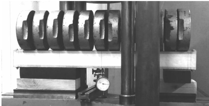
Рисунок 2 – Нагружение трехслойной балки, опертая двумя крайними участками, равномерно распределенной нагрузкой по всей длине
