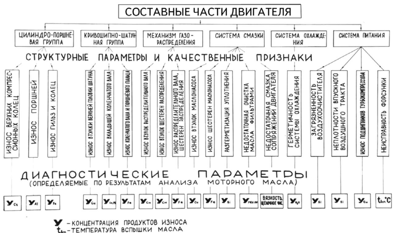
Рисунок 4 - Параметры и качественные признаки технического состояния составных частей двигателей
