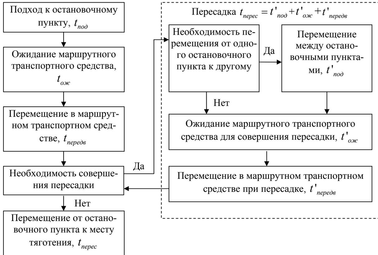
Рисунок 2 – Технологическая схема передвижения пассажиров при использовании городского пассажирского транспорта общего пользования
