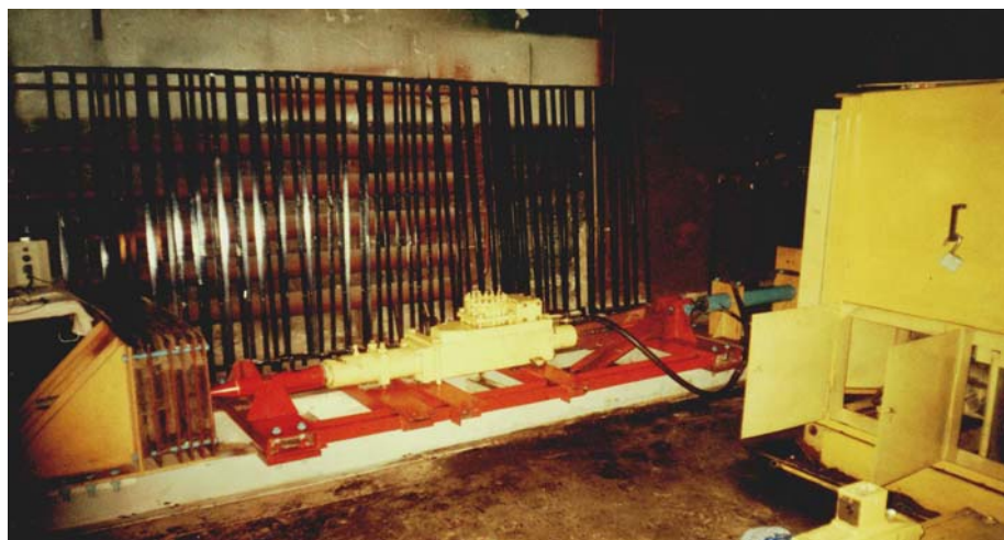
Рисунок 3 - Испытательный комплекс гидроударников с насосным агрегатом (разработан ПНИЛ «Силовые импульсные системы» ОрелГТУ. Гидроударник модели 2944)
