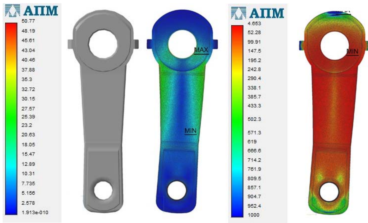
Рисунок 3 – Результаты прочностного расчета рулевой сошки автобуса модели №2 в системе APMFEM для Компас-3D
