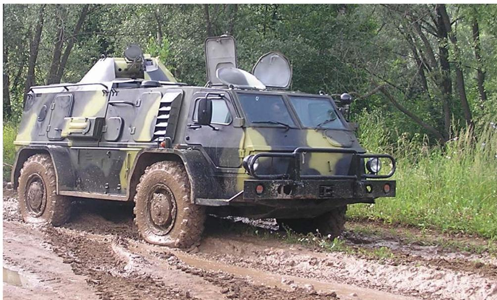
Рисунок 1 - Испытания безопасных колес по бездорожью на автомобиле ГАЗ-39371
