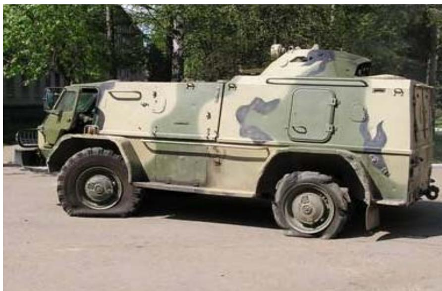
Рисунок 2 – Движение автомобиля ГАЗ-39371 на разрушенных шинах модели КИ-113 с ВДО
