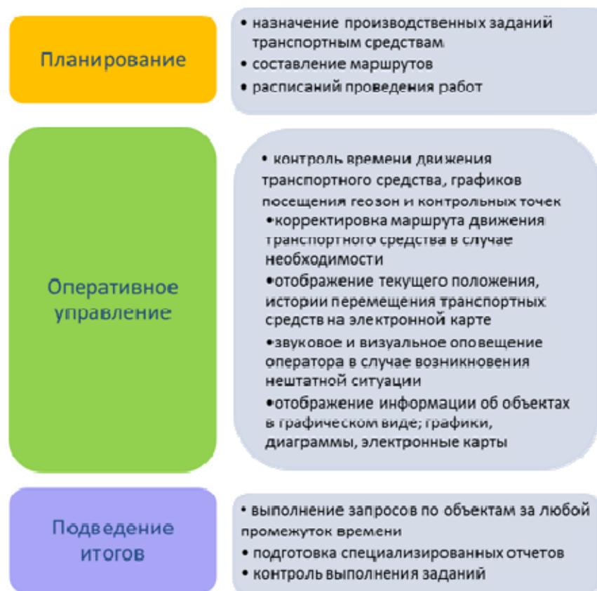
Рисунок 2 – Функции диспетчерского центра
