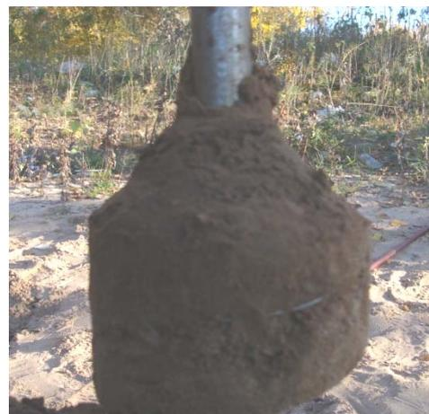
Рисунок 6 – «Жесткое» уплотненное ядро, образующееся на несущем витке лопасти ВЯ
