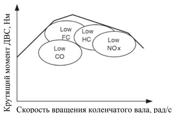
Рисунок 5 - Пример расположения оптимальных рабочих точек ДВС
