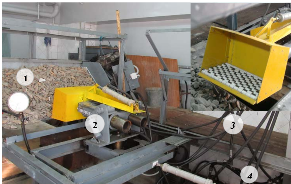
Рисунок 8 – Физическая модель рабочего оборудования одноковшового экскаватора: 1 - штабель погружаемого материала, 2 - гидравлический манипулятор, 3 - линии гидроразводки, 4 - силовая электрогидравлическая установка (маслостанция).
