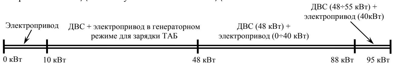
Рисунок 5 – Стратегия управления мощностью гибридной силовой установки
