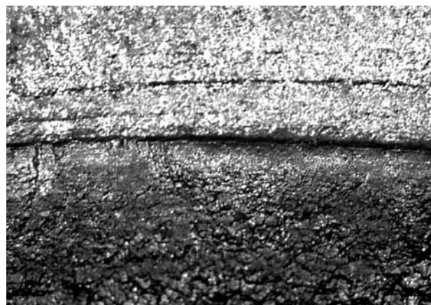
Рисунок 3 - Макроструктура излома в щеке: переход из зоны развития усталостной трещины в зону хрупкого разрушения (50:1)
