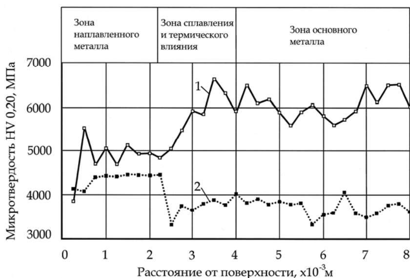
Рисунок 6 - Изменение микротвердости по глубине шейки коленчатого вала двигателя КамАЗ-740, наплавленного ПП-Нп-35В9Х3СФ под флюсом АН-348-А: 1 – наплавка с последующей закалкой с 1100 °С в воде; 2 – наплавка с последующей закалкой с 1100 °С в воде, затем отпуск при 500 °С в течение 1 ч
