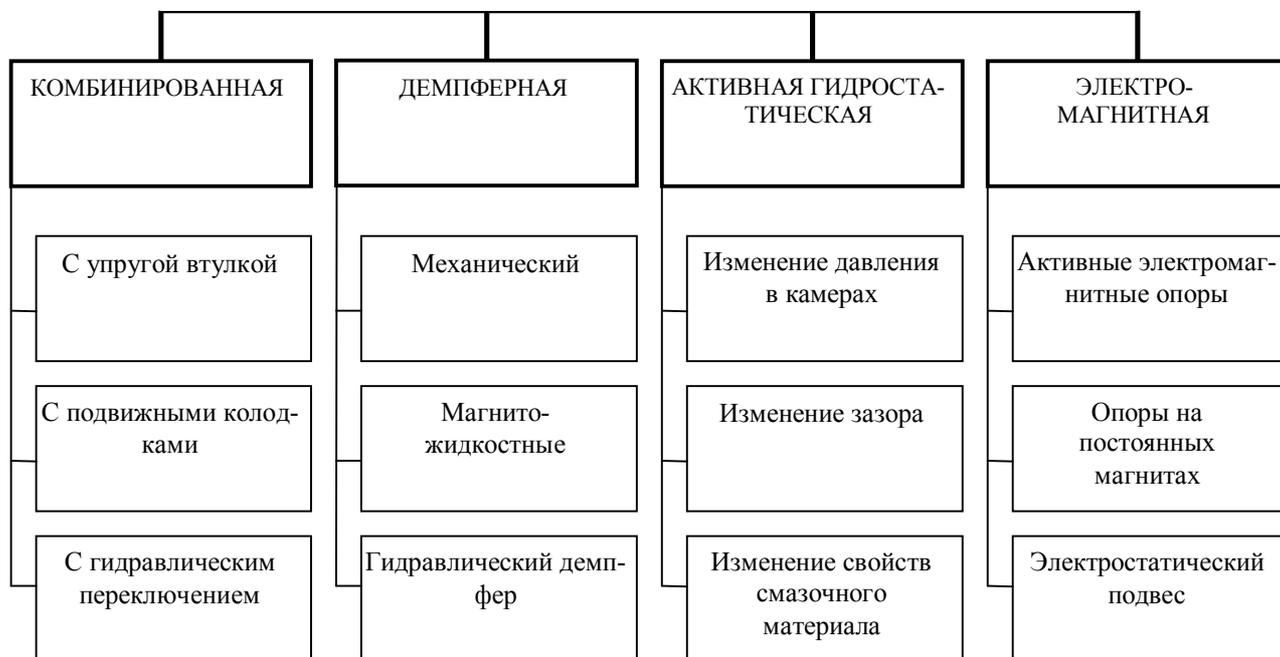
Рисунок 1 – Адаптивные опоры роторов
