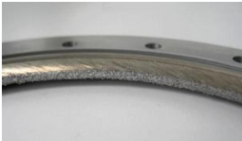
Рисунок 1 – Фотография фрагмента щёточного уплотнения
