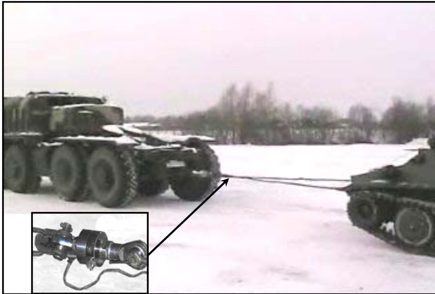
Рисунок 3 – Динамика экспериментального определения величины коэффициента сопротивления качению МТ-ЛБ при движении по обледенелой дороге
